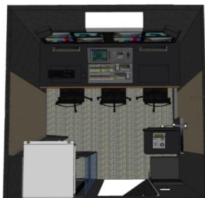
Die zweite Regie im Rüstwagen ist mit 4 Arbeitsplätzen ausgestattet
